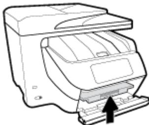
11. Поднимите дверцу устройства двусторонней печати и надавите на нее, чтобы закрыть.
