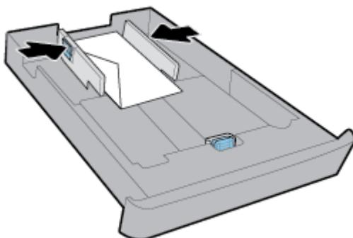
5. Кроме того, высота стопки конвертов не должна превышать отметку на левой направляющей ширины лотка.
