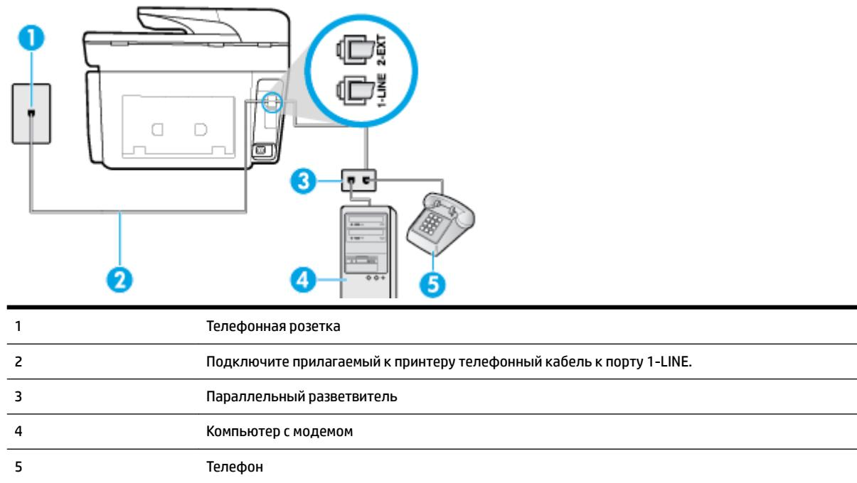
**Как настроить принтер для использования одной телефонной линии с компьютером с двумя разъемами для подключения телефонной линии**
