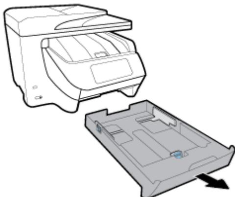
2. Проверьте пространство внутри принтера, в котором находился входной лоток. Проверьте пространство внутри принтера и извлеките замятую бумагу.
