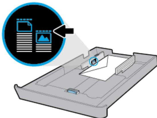
6. Отрегулируйте положение направляющих длины бумаги. Они должны касаться края стопки конвертов.
