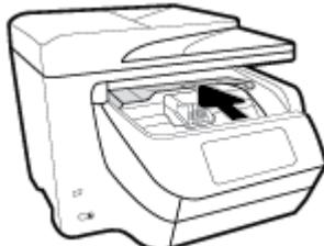
3. Нажмите на переднюю часть картриджа, чтобы освободить его, и извлеките из отсека.
