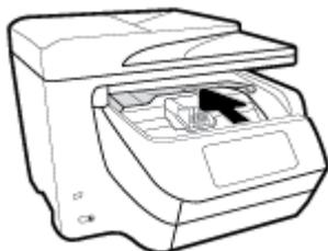
3. Нажмите на переднюю часть картриджа, чтобы освободить его, и извлеките из отсека.
