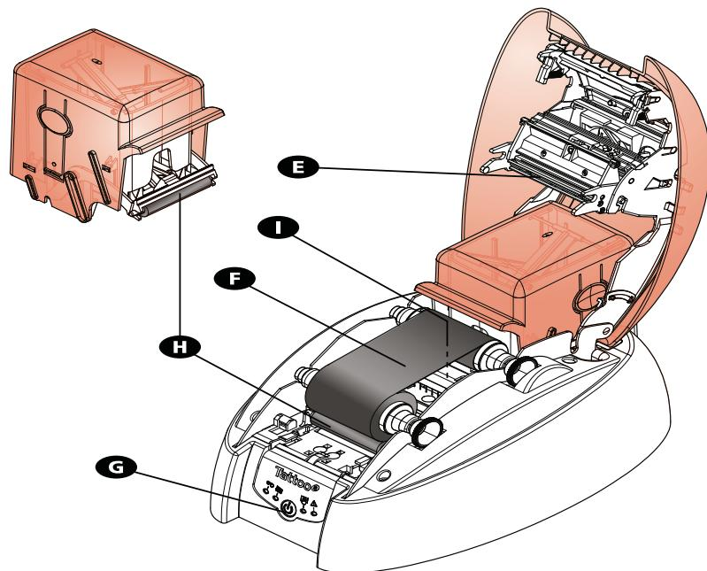
**E** - Термическая печатающая головка
