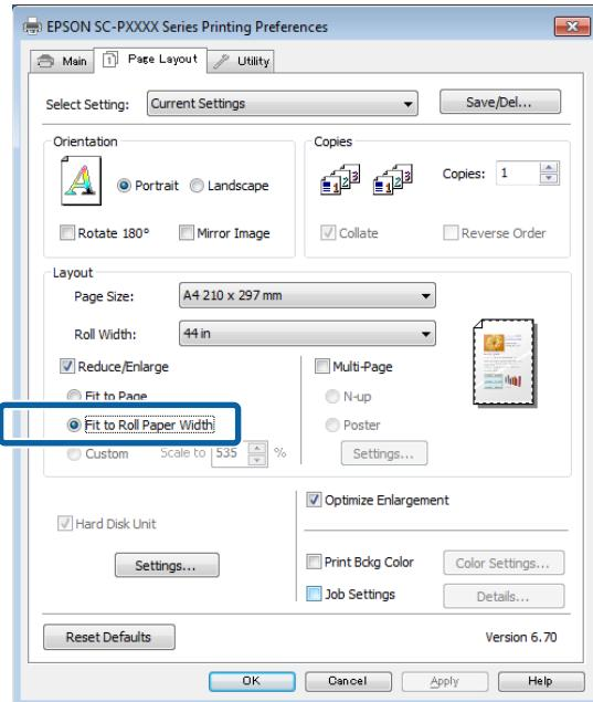
**5** В списке **Roll Width (Ширина рулона)** выберите ширину рулонной бумаги, загруженной в принтер.
