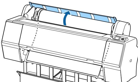
**3** Нажмите кнопку  $\%$ , на панели управления для подъема прижимного ролика.
