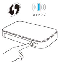
Нажмите кнопку WPS или AOSS™ на беспроводной точке доступа (маршрутизаторе).
