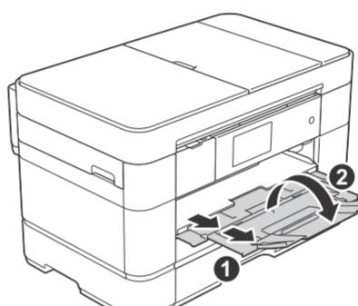
Выдвиньте опорную панель 1 и раскройте откидную панель 2.
