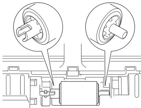
6. Сдвиньте ролик захвата бумаги (1) к левому краю, одновременно поворачивая его.
