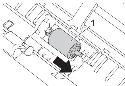
6. Придерживая пальцами ролик захвата бумаги, выньте его из устройства.
