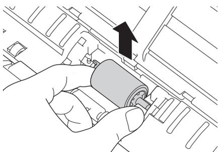
7. Очистите ролик захвата бумаги мягкой безворсовой тканью, слегка смоченной водой.
