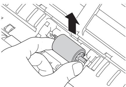
5. Установите в устройство новый ролик захвата бумаги.
