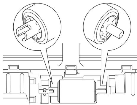
9. Сдвиньте ролик захвата бумаги (1) к левому краю, одновременно поворачивая его.
