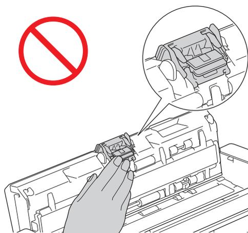
4. Придерживая пальцами крышку ролика захвата бумаги (1), сдвиньте ее вверх и снимите.
