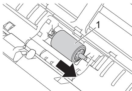
4. Придерживая пальцами ролик захвата бумаги, выньте его из устройства.
