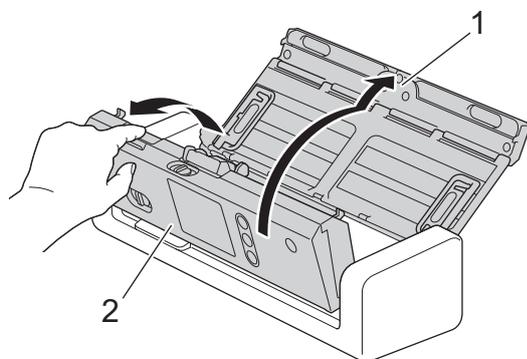
2. Придерживая пальцами крышку ролика захвата бумаги (1), сдвиньте ее вверх и снимите.
