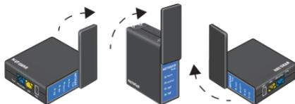
WiFi-антенна расположена внутри крышки. Для наилучшего расположения антенны поворачивайте крышку по часовой стрелке. Для достижения наилучшей производительности установите крышку в вертикальное положение.
