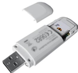
4. Вставьте крышку обратно в модем. При установке разъема не прилагайте значительных физических усилий, чтобы не повредить его.
