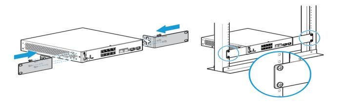
**Примечание.** Коммутаторы HP 2530 с 24 и 48 портами можно устанавливать в четырехопорных стойках и отсеках, используя комплект направляющих HP X410 Switch Rail Kit (J9583A). Инструкции по использованию комплекта можно найти в документации, прилагаемой к комплекту.
