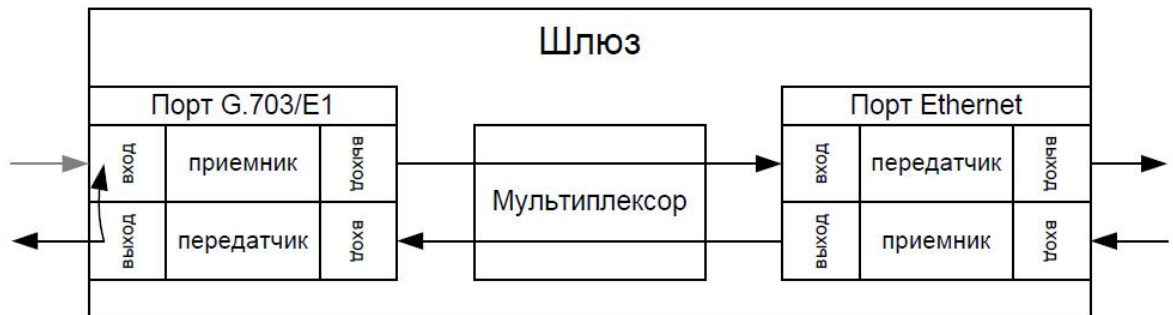
Схема прохождения сигнала в режиме удаленного шлейфа.
