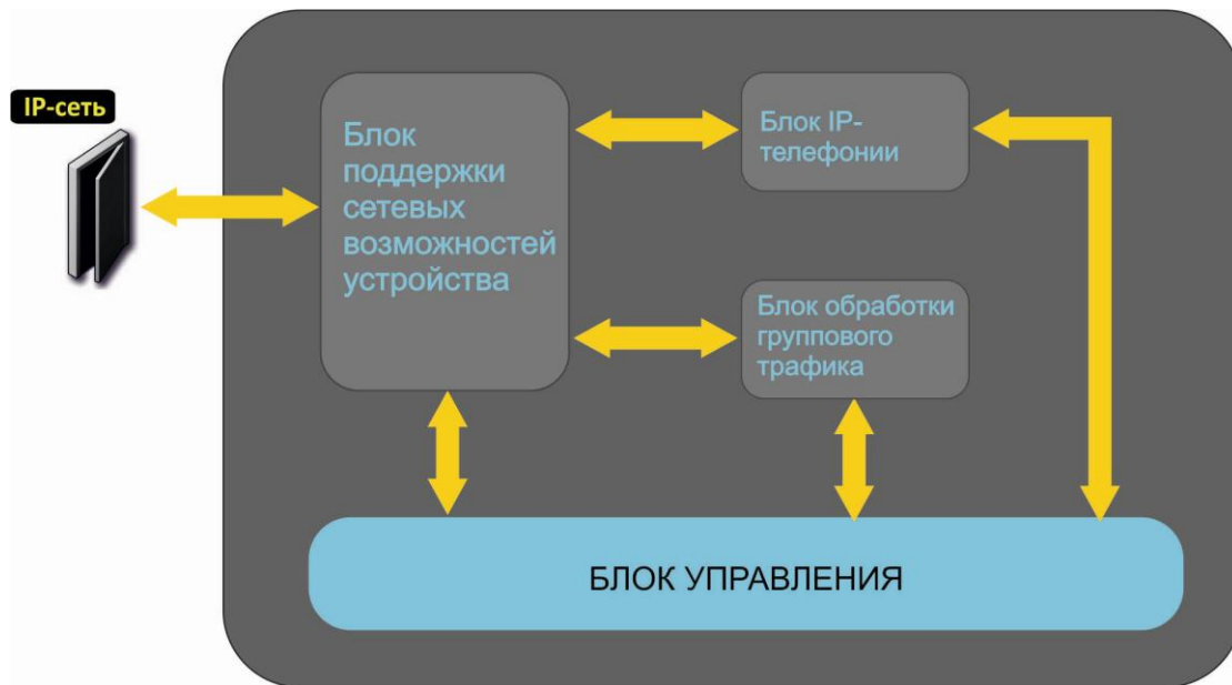
Рисунок 4 – Функциональная схема RG-1400
