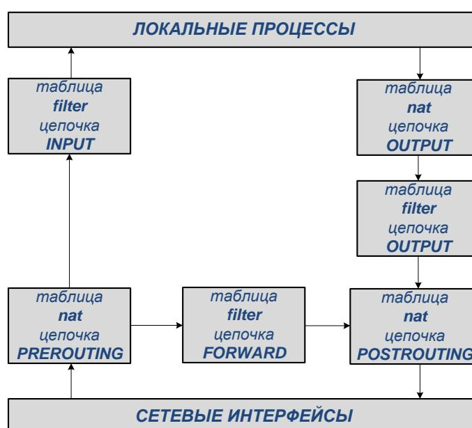
*Рисунок 5 – Последовательность обработки пакетов и цепочки правил*
