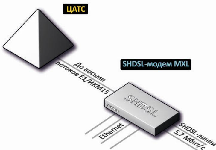
Рисунок 1 – Схема подключения
