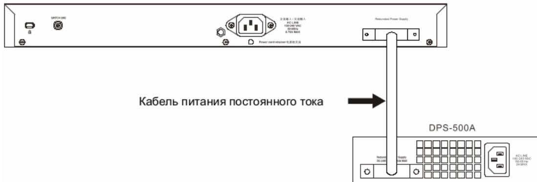
Рисунок 10 — Подключение DPS-500A к коммутатору
