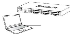
2. Для выполнения входа в Web-интерфейс компьютеру должен быть назначен IP-адрес из того же диапазона, в котором находится IP-адрес коммутатора. Например, если коммутатору назначен IP-адрес 10.90.90.90 с маской подсети 255.0.0.0, то компьютеру должен быть назначен IP-адрес вида 10.x.y.z (где x/y - это число от 0 до 255, z - число от 1 до 254) с маской подсети 255.0.0.0.
