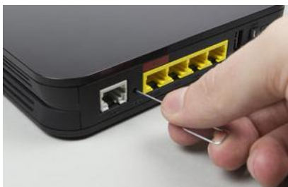
Рис. 2. Расположение кнопки Reset
