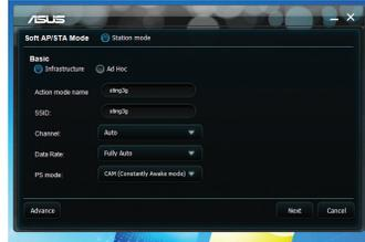
**Рабочий режим и имя сети (SSID)** - Введите или выберите из списка SSID для AP или станции, к которой Вы хотите подключиться. SSID должен содержать печатаемые символы и иметь не более 32-х символов, например “Wireless”.
