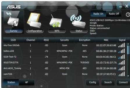
**SSID** - Показывает имя беспроводной сети, к которой подключается беспроводной адаптер.
