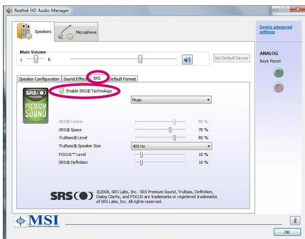
**Шаг 3.** Выберите вид звукового материала, который будет прослушиваться. Функция SRS Premium Sound автоматически обработает указанные аудиосигналы для обеспечения качественного воспроизведения.
