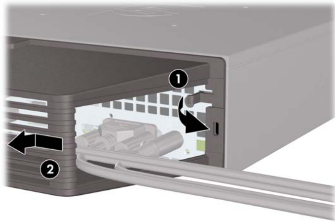
Рисунок 5-23 Удаление крышки порта
