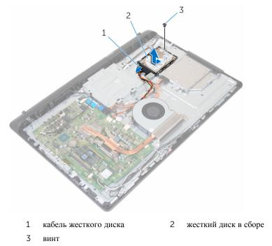
Выверните винты, которыми каркас жесткого диска крепится к жесткому диску.
