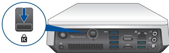
5. Сдвиньте верхнюю крышку в направлении задней части устройства, пока она не снимется.
