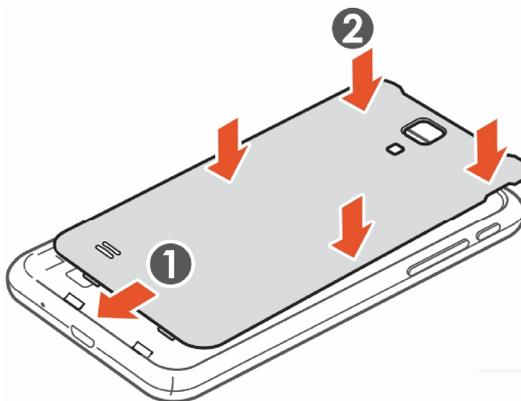
Защелкните крышку, проследите, чтобы края крышки плотно прилегали к корпусу.
