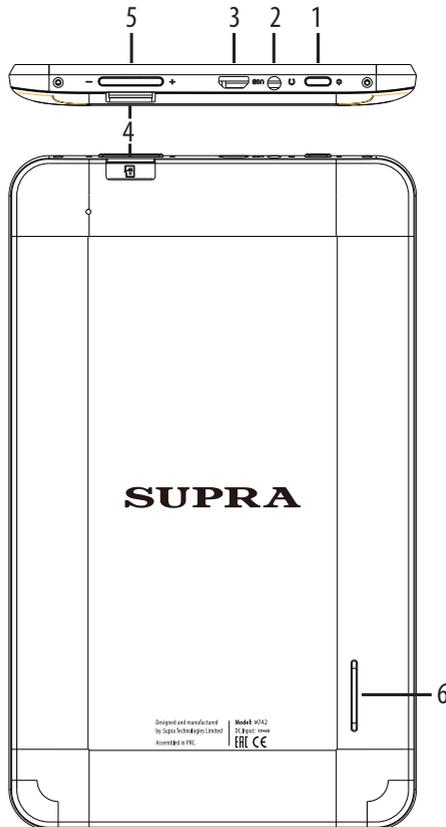
1. Кнопка включения и выключения
