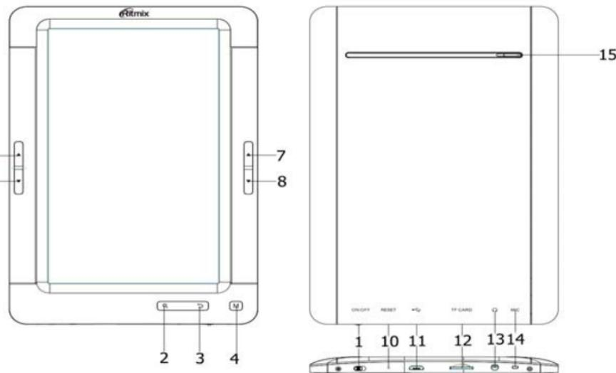
1. Выключатель питания: используется для полного отключения устройства (при необходимости полной перезагрузки книги)
