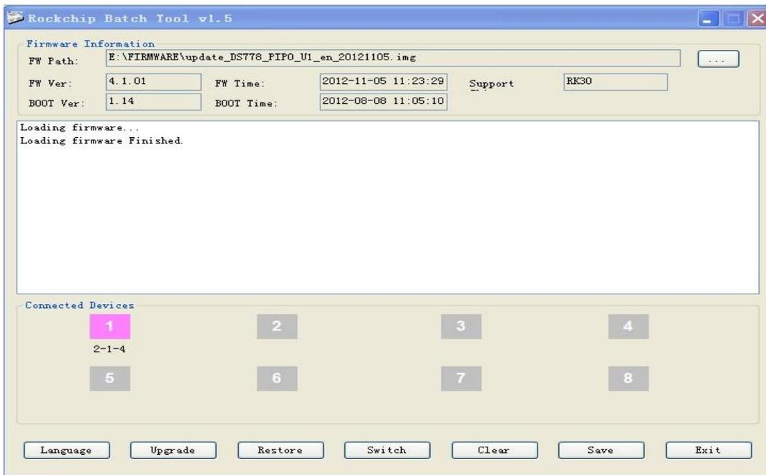
По окончании обновления планшет включится автоматически, и это означает, что его можно отсоединить от компьютера.
