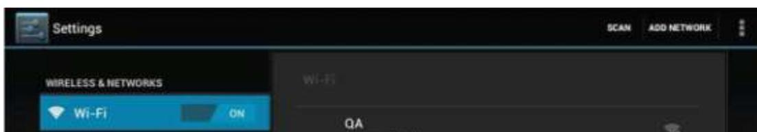
Планшет отображает все доступные подключения. Для подключения нажмите на выбранную точку доступа. При необходимости введите защитный пароль и нажмите «Подключиться». Подключение устройства к сети указывает индикатор
