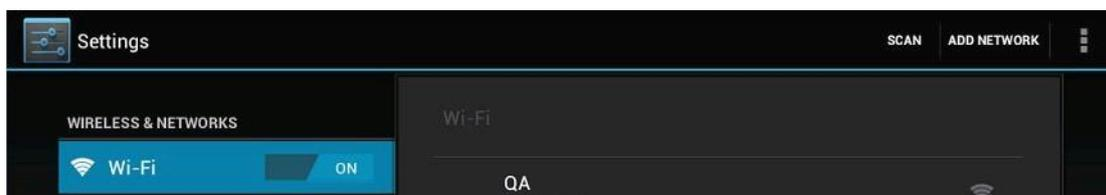
Планшет отображает все доступные подключения. Для подключения нажмите на выбранную точку доступа. При необходимости введите защитный пароль и нажмите «Подключиться». Подключение устройства к сети указывает индикатор
