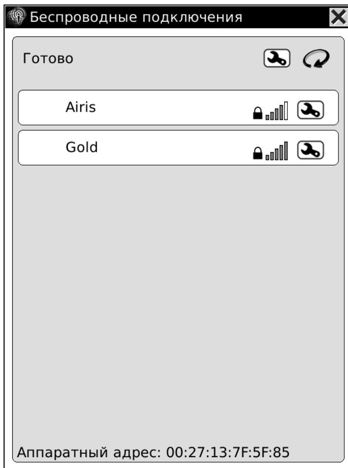
Если точка доступа защищена, нужно ввести пароль в графу PSK с помощью виртуальной клавиатуры и нажать **Да**.
