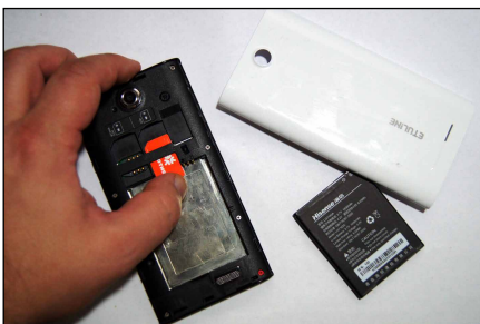
Рис. 2.41. Вставка SIM-карты в смартфон ETL-S4521
