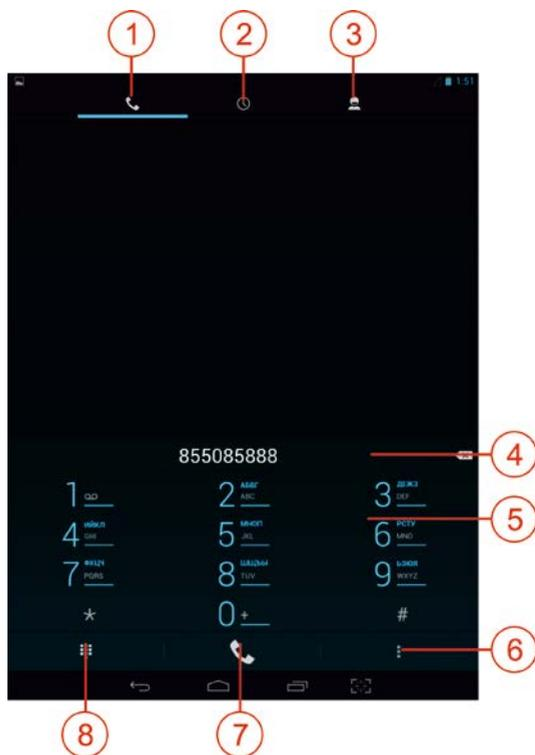
7. Клавиша начала набора номера. Если в устройстве установлены две SIM-карты, то при нажатии клавиши до набора номера потребуется уточнить, с какой карты осуществлять вызов.
