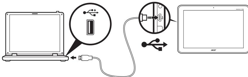
Штекер micro USB вставьте в разъем планшетного ПК, а штекер на другом конце USB-кабеля - в разъем USB в ПК.
