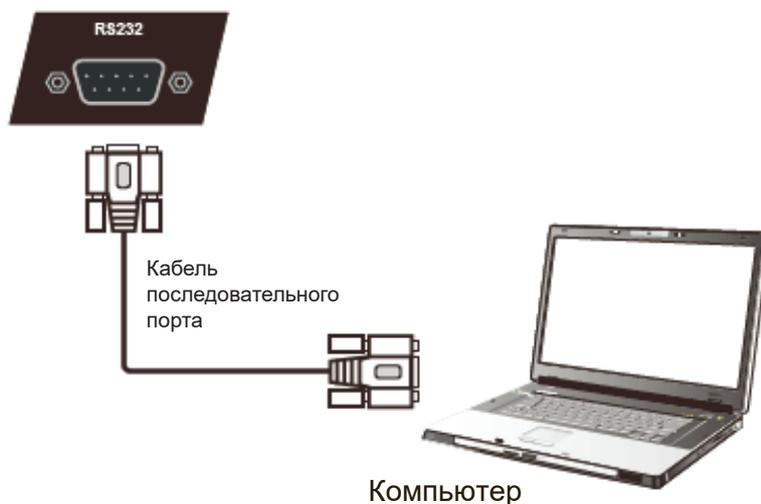
Через соединение RS-232 можно включить ViewBoard, отрегулировать громкость или переключить источник входного сигнала с удаленного ПК или консоли. ViewSonic также предоставляет простой в использовании инструмент управления — vController. Найти описание и загрузить ПО можно на сайте ViewSonic. Дополнительную информацию о подключении пульта дистанционного управления см. в таблице протокола RS-232.
