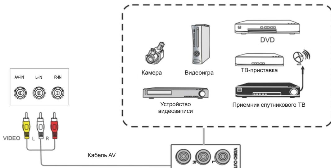
1. Соедините 3-цветным AV-кабелем порты AV IN дисплея и порты AV OUT периферийного устройства (AV-кабель: желтый – Video, красный – Audio-R, белый – Audio-L).
