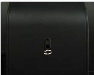
Чтобы поднять или опустить монитор, извлеките фиксирующий штифт подставки.
