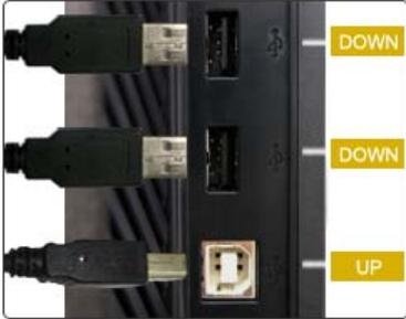
**UP (Восходящий порт USB):** Используя USB cable (USB кабель), подсоедините порт **UP** монитора к USB порту компьютера.
