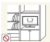
Не устанавливайте изделие в тесных местах с плохой вентиляцией, например на книжных полках или в стенных шкафах.
