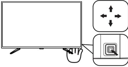
Для вызова экранного меню на мониторе Philips используется кнопка-джойстик, расположенная на задней панели монитора. Кнопка выполняет функции джойстика. Для перемещения курсора нажимайте на кнопку в четырех направлениях. Нажмите на кнопку для выбора нужного параметра.
