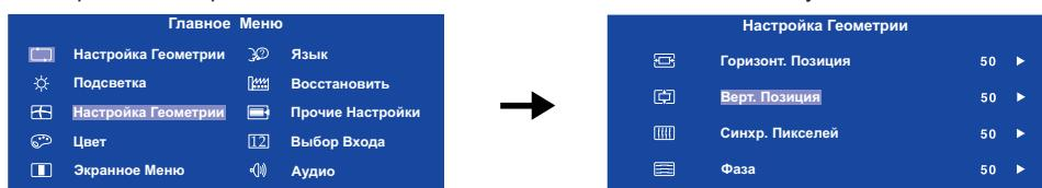
Для изменения установок вертикального положения используйте кнопки **◀ / ▶**. При настройке должно изменяться вертикальное положение всего экрана.
