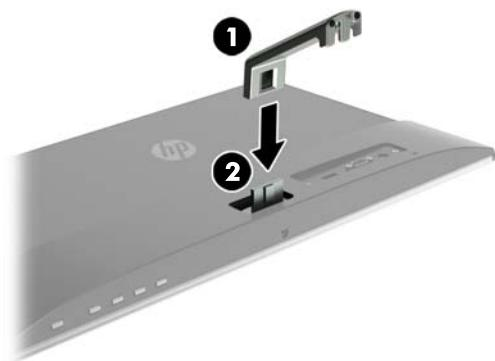
3. Вставьте основание (1) в нижнюю часть кронштейна подставки так, чтобы совпали центровые отверстия. Затяните винт (2) на обратной стороне основания.
