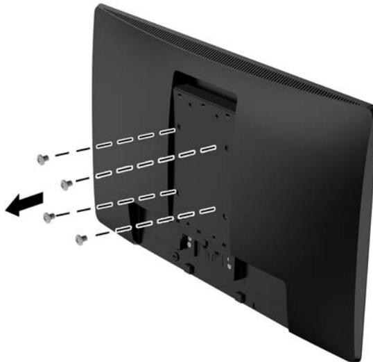
4. Прикрепите монтажную панель к стене или поворотной кронштейне по вашему выбору с помощью четырех винтов, входящих в комплект крепежной пластины.
