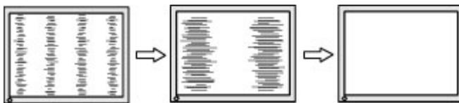
3. Если после настройки синхроимпульсов изображение на экране мигает, размытое или имеются полосы, перейдите к разделу настройки фазы синхроимпульсов.
