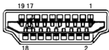
19-контактный кабель для передачи сигналов цветного изображения
