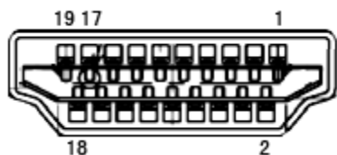
19-контактный кабель для передачи сигналов цветного изображения
