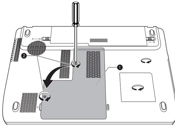
1. Крышка отсека модулей памяти    2. Винты
