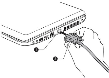
1. Порт для подключения внешнего монитора RGB 2. Кабель монитора
