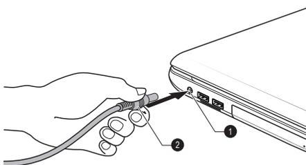
1. Гнездо для подключения источника постоянного тока с напряжением 19 В
