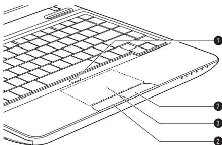
1. Кнопка включения/выключения устройства Touch Pad
