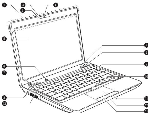
1. Антенна для подключения к беспроводной локальной сети (не видна)
