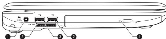
1. Гнездо для подключения источника постоянного тока с напряжением 19 В
