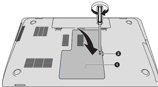
1. Крышка отсека модулей памяти    2. Винт
