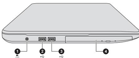
1. Гнездо для подключения источника постоянного тока с напряжением 19 В
