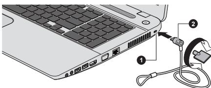
1. Разъем защитного замка-блокиратора
