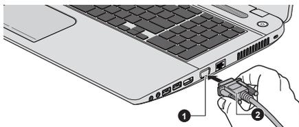
1. Порт для подключения внешнего монитора RGB
