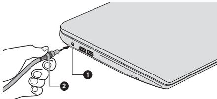
1. Гнездо для подключения источника постоянного тока с напряжением 19 В
