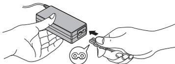
*Рисунок 2-2 Подключение шнура питания (с 3-контактной вилкой) к адаптеру переменного тока*
