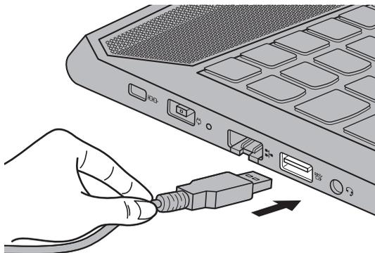
При первом подключении устройства USB к одному из USB-портов компьютера ОС Windows автоматически устанавливает драйвер для данного устройства. После установки драйверов устройство можно подключать и отключать без каких-либо дополнительных действий.
