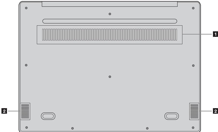
**1 Вентиляционные решётки**      Обеспечивают подачу воздуха для охлаждения компьютера.
