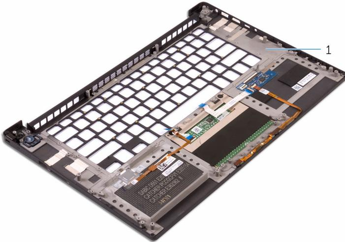
**Рисунок 37. Снятие упора для рук в сборе**
