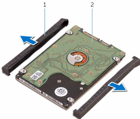
**Рисунок 8. Снятие крышки жесткого диска**
