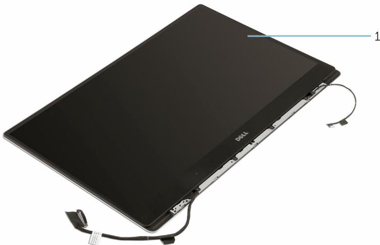
**Рисунок 30. Дисплей в сборе**
