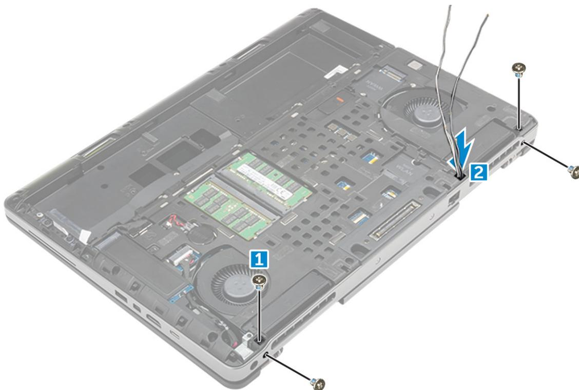
5 Снятие дисплея в сборке:
