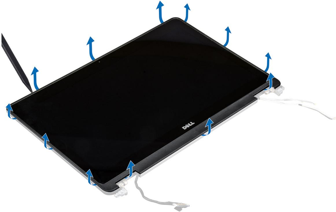
b Приподнимите панель дисплея и переверните ее, чтобы получить доступ к кабелю eDP и кабелям дисплея.
