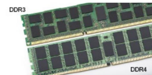
**Рисунок 1. Различие в установочных выемках**
