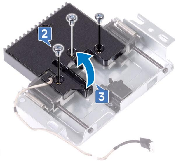
6 Чтобы снять модуль выдвигающейся камеры, выполните следующие действия.
