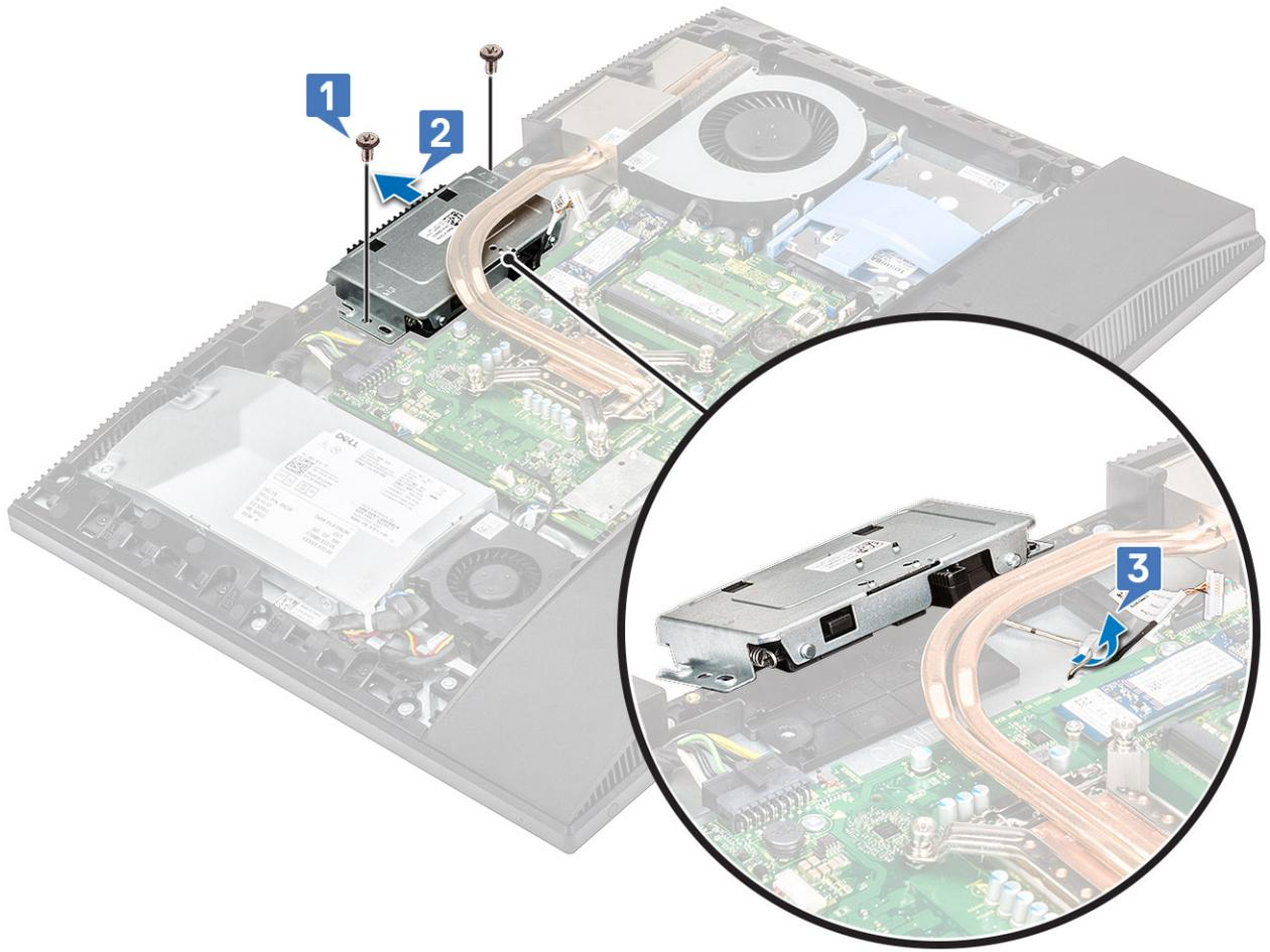
5 Чтобы снять лицевую панель выдвигающейся камеры, выполните следующие действия.
