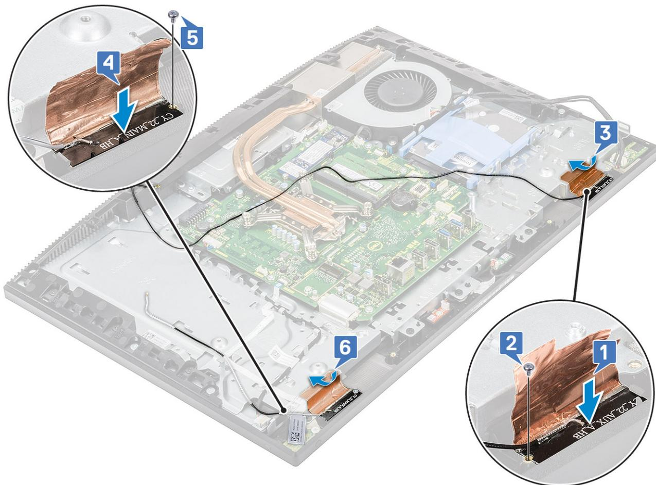
d Проложите антенные кабели через направляющие желобки в основании дисплея в сборе [1,2].
