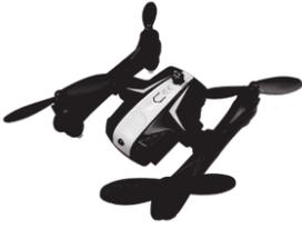
2. Установите дрон на плоской горизонтальной поверхности. Сначала включите питание пульта управления. Затем, чтобы включить питание модели, нажмите кнопку на верхней части корпуса боевого дрона. (см. рисунки). Индикаторы начнут быстро мигать. Когда индикаторы станут мигать медленно, это значит, что идет процесс установки связи пульта управления с дроном.
