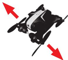
1. Аккуратно поверните моторы боевого дрона в рабочее положение (см. рисунки) и убедитесь, что аккумулятор дрона надежно закреплен.
