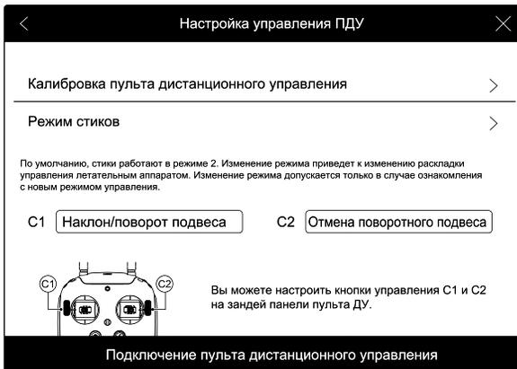
Нажать на кнопку C1 или C2 для переключения режима наклон/поворот. Колесо управления подвесом может быть использовано для вращения подвеса. Нажать на C1 или C2 для выхода из режима управления поворотом подвеса.
