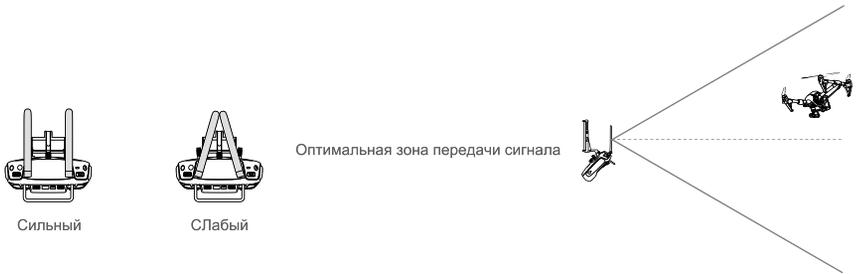
Необходимо убедиться, что полет аппарата осуществляется в пределах оптимальной зоны передачи сигнала. Для обеспечения оптимальной передачи сигнала, необходимо изменить положение пользователя и летательного аппарата соответствующим образом.
