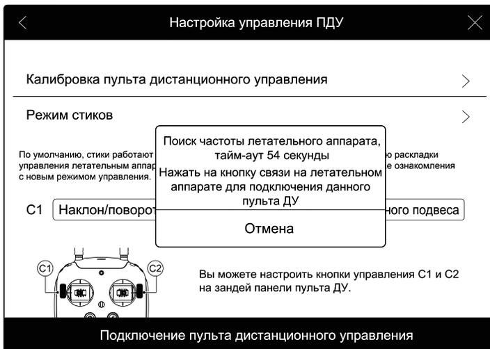
5. Кнопка связи расположена на носовой части летательного аппарата, как показано на рисунке ниже. Для установления подключения необходимо нажать на кнопку связи. При успешном подключении, индикатор состояния пульта дистанционного управления загорится зеленым.
