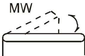
Радиоприемник оснащен встроенной высокочувствительной ферритовой антенной. Для улучшения качества приема в диапазоне MW(AM) вращайте устройство горизонтально.
