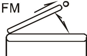
Для улучшения качества приема в диапазоне FM выдвиньте телескопическую антенну (1) радиоприемника на нужную длину и отрегулируйте угол ее наклона.
