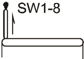
Для улучшения качества приема в диапазоне SW1-8 выдвиньте телескопическую антенну (1) радиоприемника на полную длину и переведите ее в вертикальное положение.
