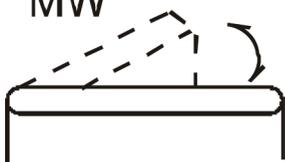
Радиоприемник оснащен встроенной высокочувствительной ферритовой антенной. Для улучшения качества приема в диапазоне MW(AM) вращайте устройство горизонтально.
