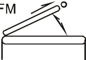
Для улучшения качества приема в диапазоне FM выдвиньте телескопическую антенну (1) радиоприемника на нужную длину и отрегулируйте угол ее наклона.
